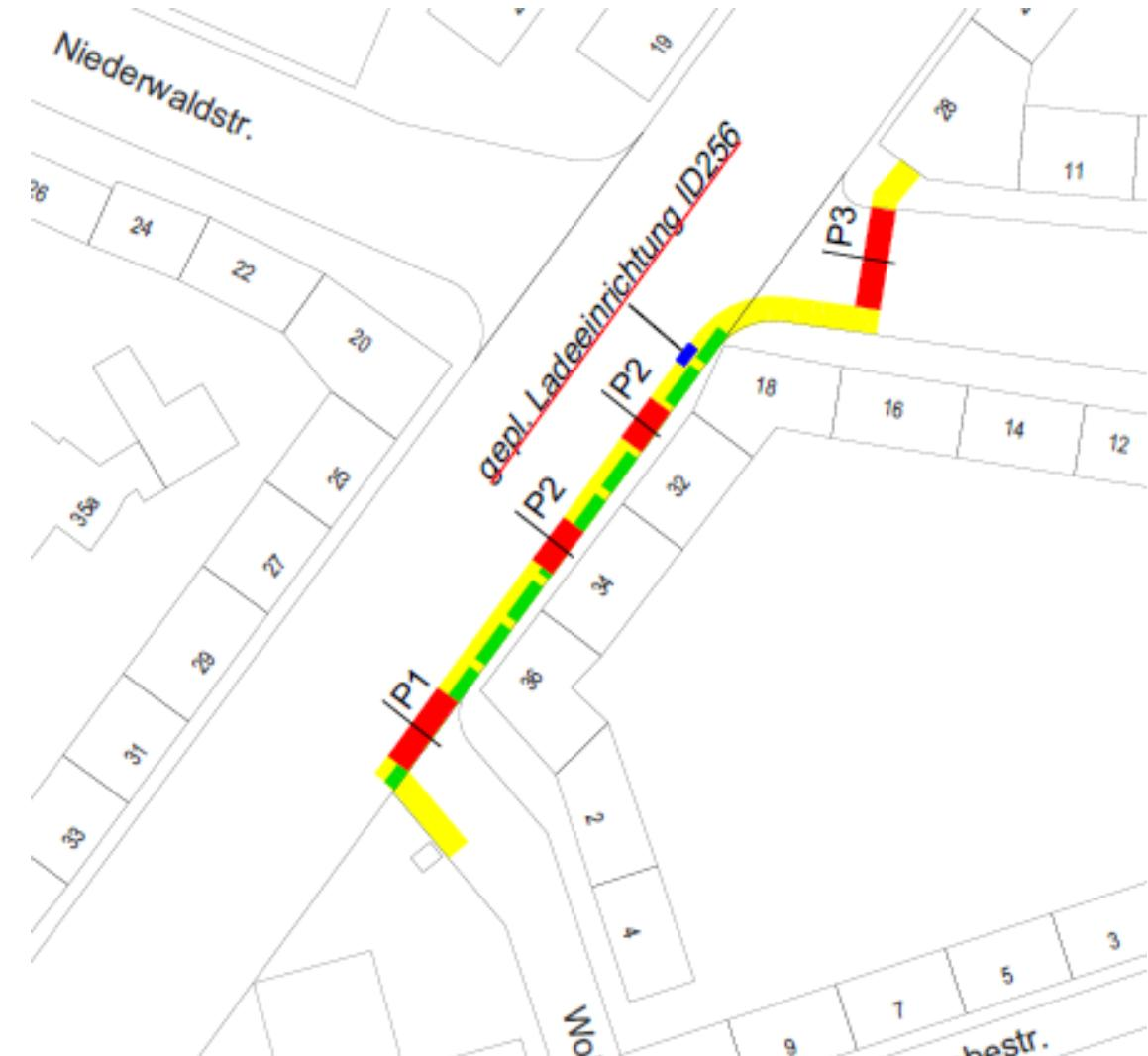
Durch die Beantragung einer Leistungserhöhung für einen Hausanschluss (Kundenprojekt) muss das Stromnetz in diesem Bereich verstärkt werden. Gleichzeitig werden parallel in der Trasse liegende Stromkabel und anliegende Hausanschlüsse erneuert.
