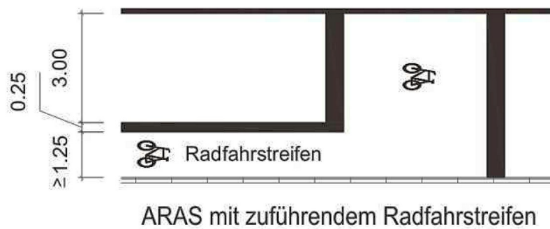
Abbildung 1: Schemazeichnung „Aufgeweitete Radaufstellstreifen“ (ARAS).
