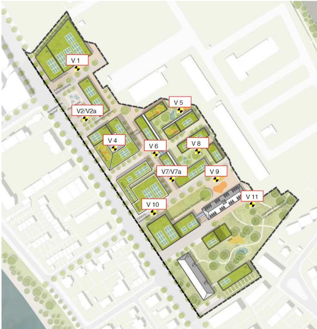
● V ... Versickerungsbohrung Ø 70 mm bis 50 mm
