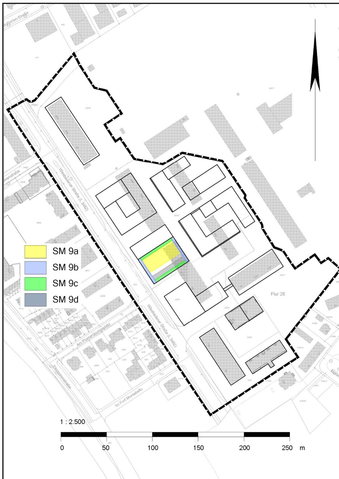
Karte 9: Schallschutzmaßnahmen SM 9 a bis SM 9d: Schallschutzmaßnahmen Parkhaus
