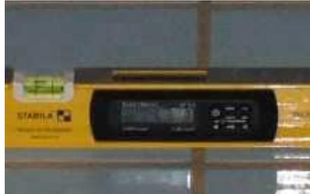
Abb. 25 # 3,0 % Gefälle zum BE Abb. 26 # 1,3 % Gefälle zum BE
