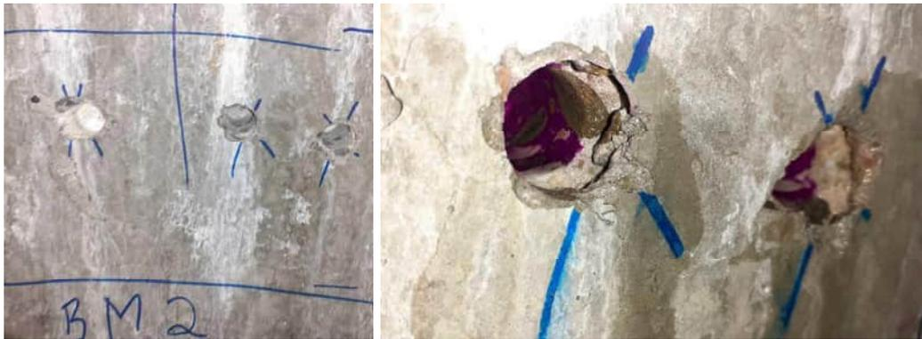
Die Carbonatisierungstiefe wurde zu ca. 8 mm bestimmt. An der Probestelle war eine dünne Schicht des Betons hohlliegend.
