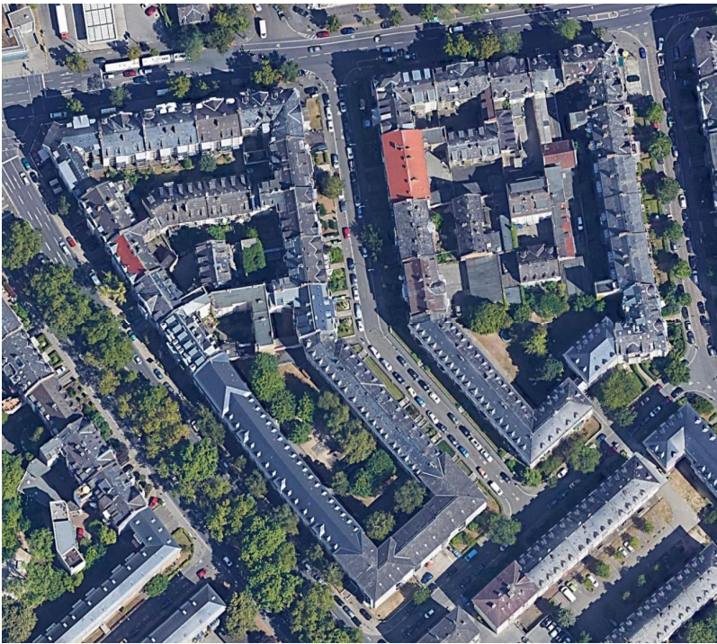
Bei der Luftaufnahme zweier Blöcke im Rheingauviertel kann man deutlich den Gestaltungsunterschied bei den Hofbereichen sehen: dicht überbaut bei der gründerzeitlichen Bebauung und als Freiflächen gestaltet und begrünt beim Siedlungsbau der Zwischenkriegszeit.
