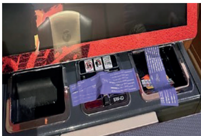
Versiegelung Geldspielgerät (z. B. bei fehlendem Anschluss an das OASIS-System)
