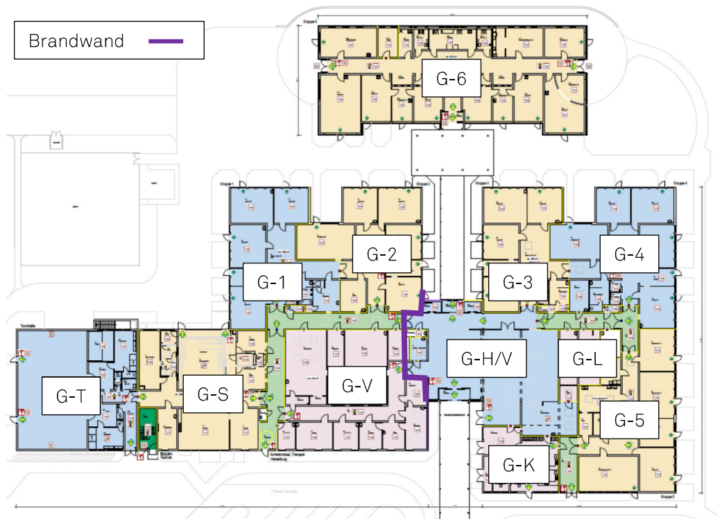
ABB. 2-1: ABSCHNITTE IM ERDGESCHOSS
