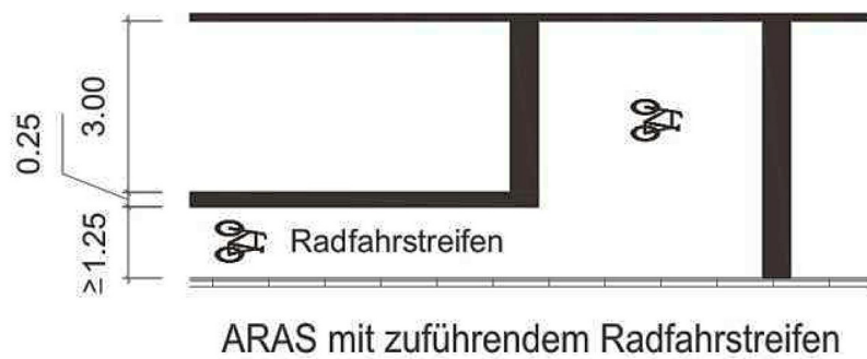
Abbildung 1: Schemazeichnung „Aufgeweitete Radaufstellstreifen“ (ARAS). Quelle: Radverkehrskonzept der LH Wiesbaden (2015), Bild 5-23, S. 77.
