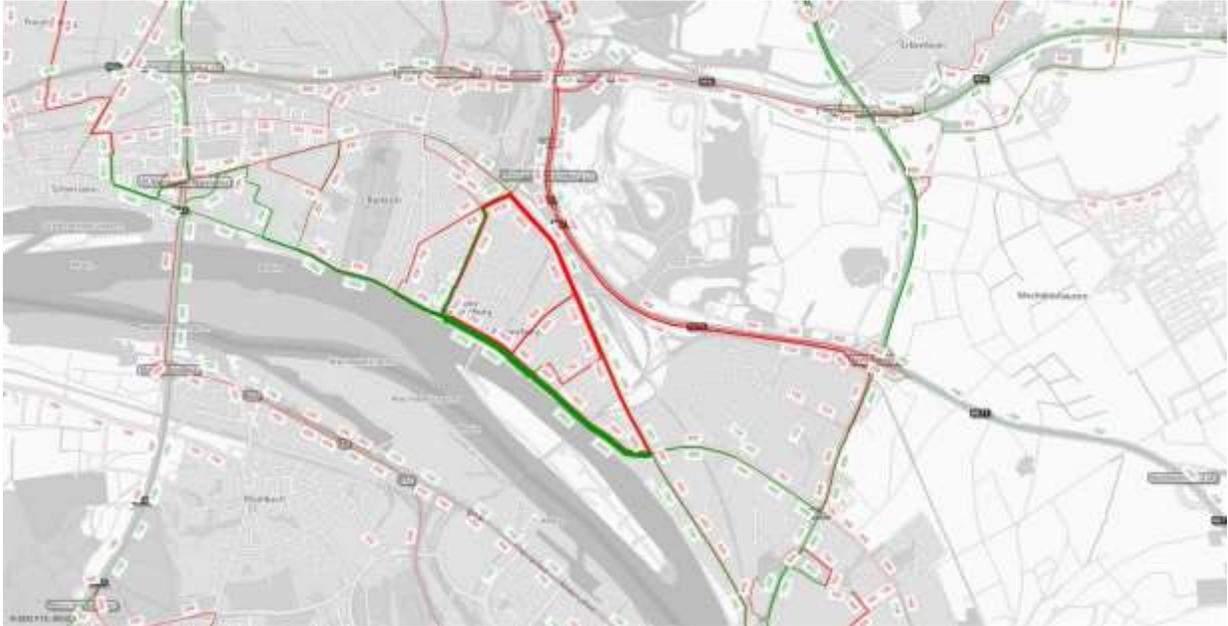
Abbildung 21: Geänderte Kfz-Verkehrsströme in der Abschnittsvariante 3.4a (Biebricher Straße)
