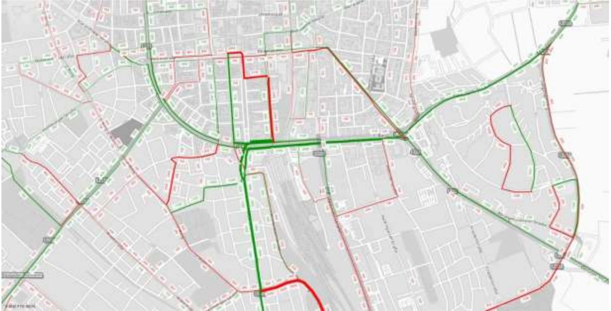
Abbildung 17: Geänderte Kfz-Verkehrsströme in den Abschnittsvarianten 1.1 und 2.1 (Biebricher Allee)
