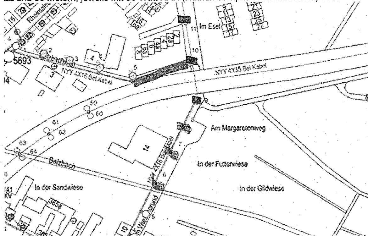
Lph. 6 Meter / 50 Watt NAH; Lph. 5,5 Meter / 50 Watt NAH; Lph. 4 Meter / 50 Watt NAH
