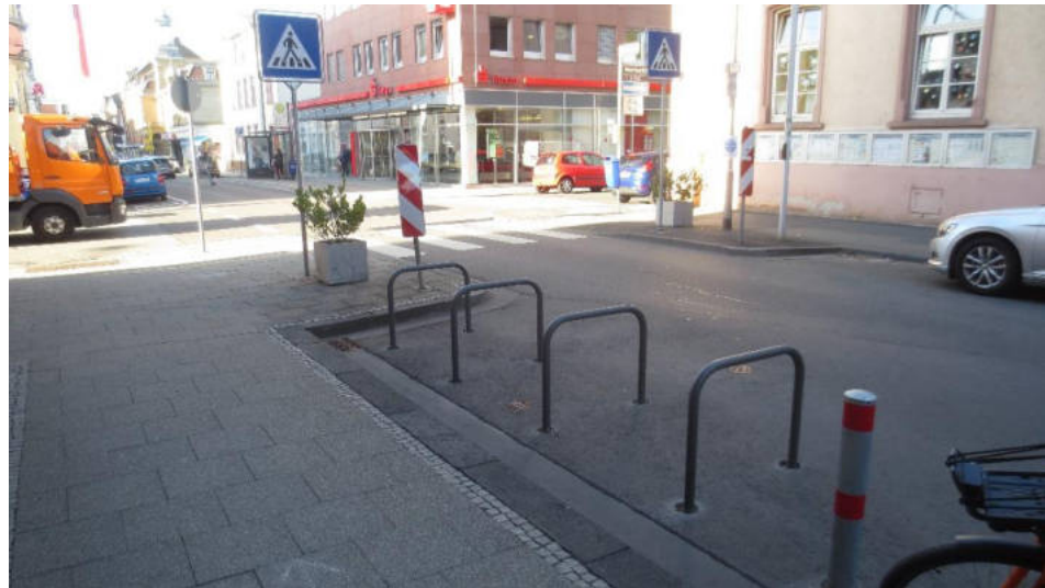
Abbildung 34: Beispiel für eine gelungene Anordnung von Fahrradabstellanlagen in einem Knotenpunktbereich
