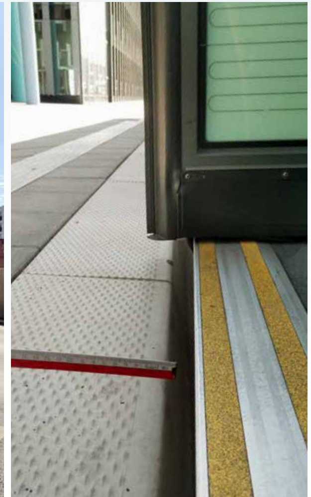
Abbildungen 25: Durch die korrekte Anfahrt wird die optimale Schnittstelle zwischen Haltestelle und Fahrzeug gewährleistet. Foto aus dem Regelbetrieb in Frankfurt, Haltestelle „Dubliner Straße“
