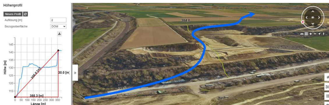
Abbildung 40 - Möglicher Streckenverlauf am Südportal des Verbindungstunnels
