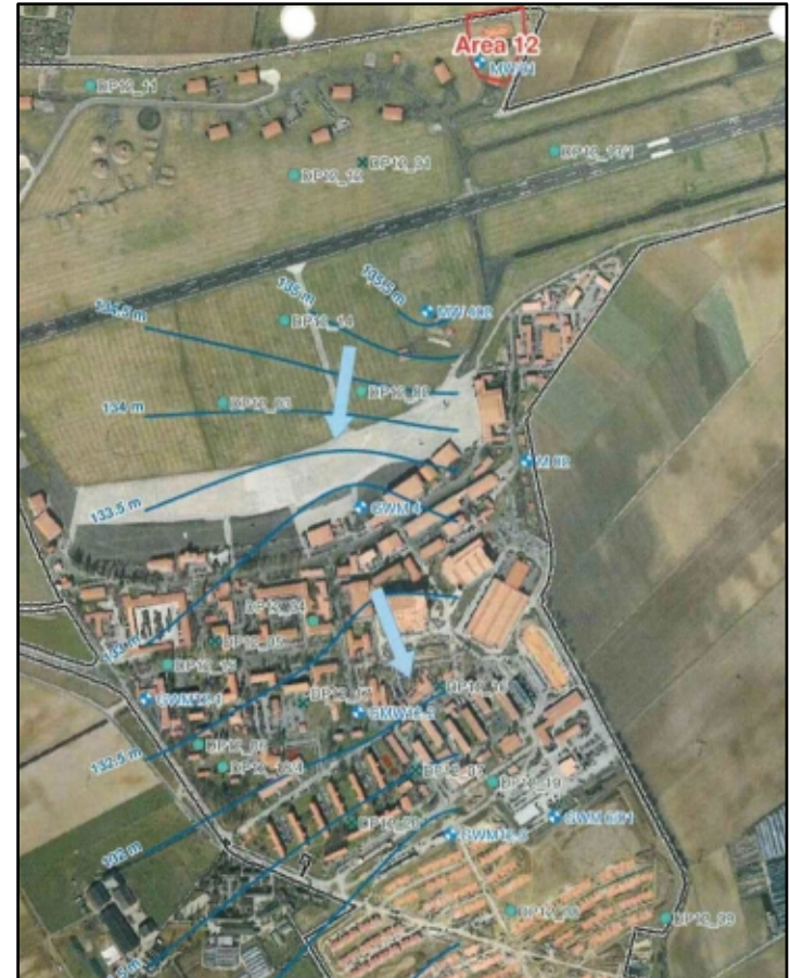
GW-Messstellen und ungefähre GW-Fließrichtung
