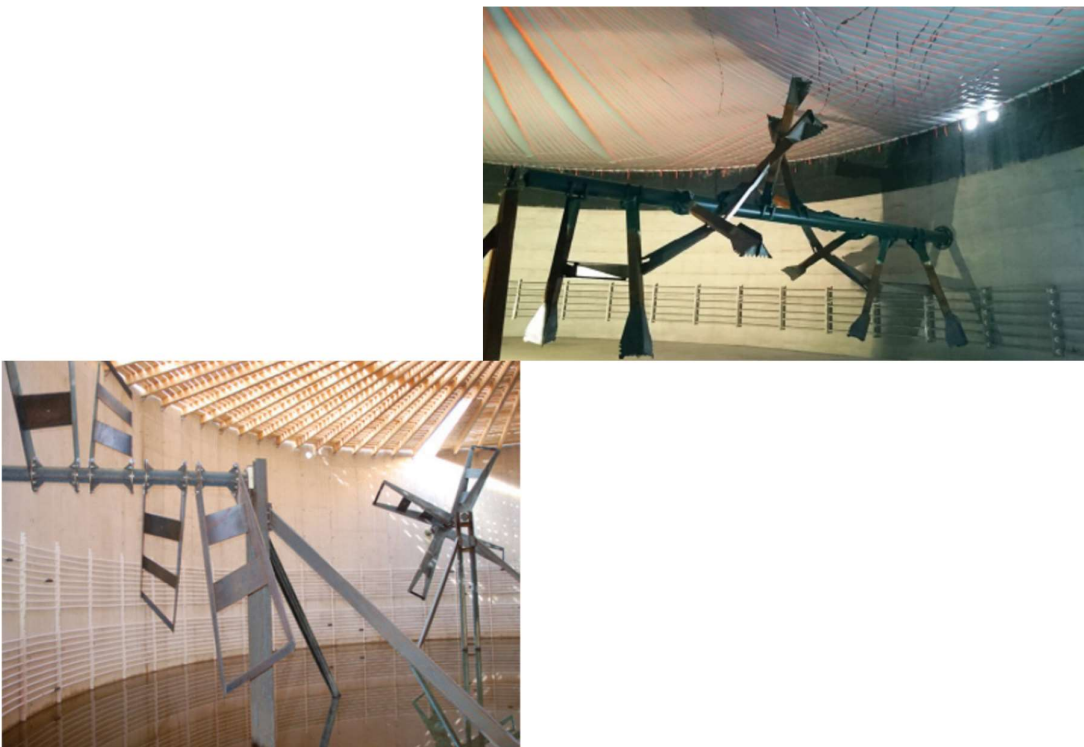
Abbildung 6: Blick in einen Rührwerksbehälter mit Paddelrührwerk
