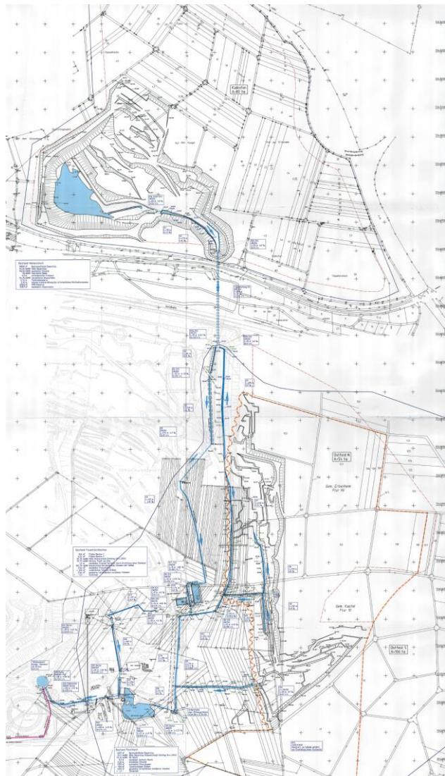
Abb. 4-1: Regenwasserentwässerung Kalkofen und Dyckerhoffbruch (U1/)
