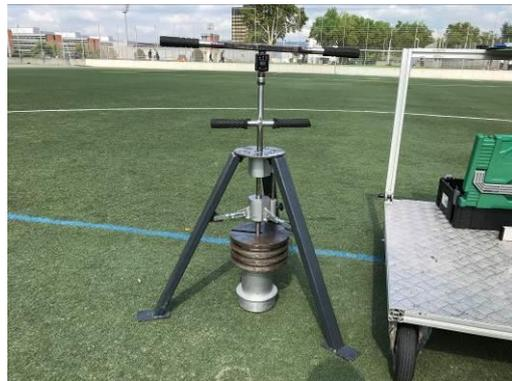
Abb.10: Prüfung Drehwiderstand vor Ort
